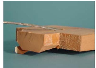
Abb. 13: zerstörtes Auflager
