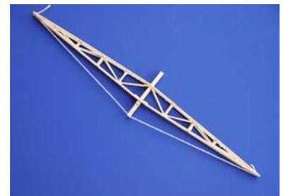
Abb.4: Arbeitsmodell mit einfacher Unterspannung
