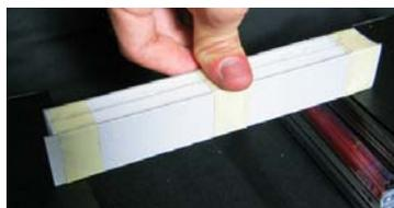
Abb. 5 Test - Sandwich-Träger
