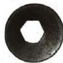
Abb. 4: durchstanzte Unterlegscheibe
